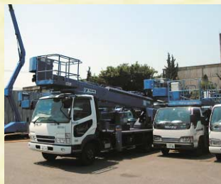
[写真1] 高所作業用車両
