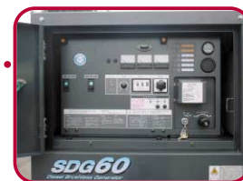
扉を開くと電圧選択スイッチと出力選択スイッチが。これを同圧に設定すればエンジンが作動
