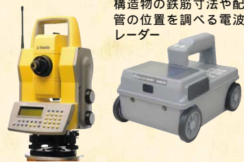
望遠鏡で2点間の方位角・高度角を測るトランシット
