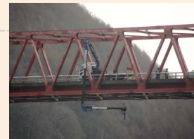
レンタルデビューを果たした新型橋梁点検車「橋竜」
