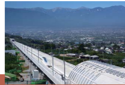
山梨県の実験線を走行するリニア Linear maglev train running along the test track in Yamanashi Prefecture
