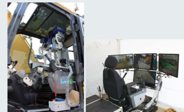
建設機械の運転席に設置した双腕双脚の人間型ロボットを、コックピット型コントローラで遠隔操縦する「DOKA ROBO」 “DOKA ROBO” uses cockpit controllers to remotely operate a two-arm, two-leg humanoid robot placed in the driver’s seat of construction equipment
