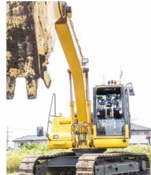
建設機械の運転席に設置した双腕双脚の人間型ロボットを、コックピット型コントローラで遠隔操縦する「Kana Robo」 “Kana Robo” uses cockpit controllers to remotely operate a two-arm, two-leg humanoid robot placed in the driver’s seat of construction equipment
